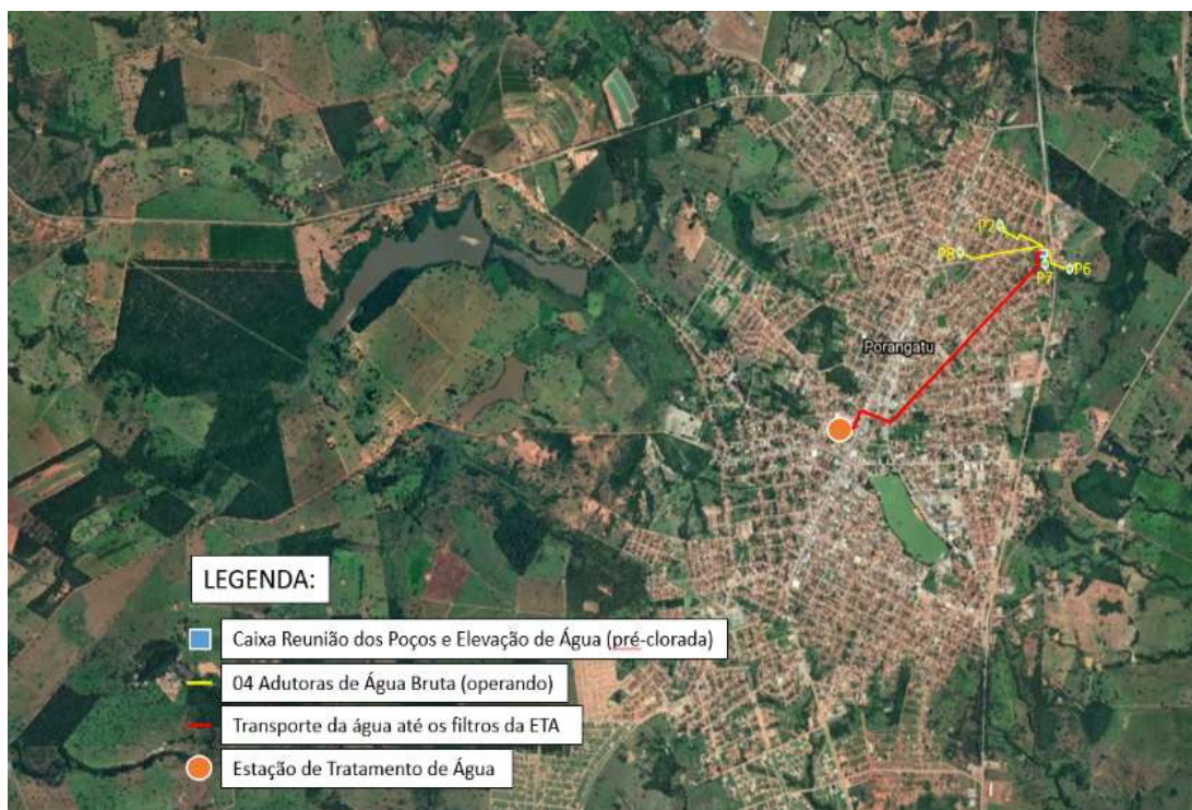
Figura 32: Esquema dos Sistemas de poços independentes de captação e adução de água bruta (Fonte: Website do Google Maps®, 2021)
