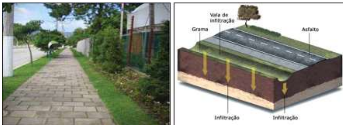
Figura 91: Vala de detenção ao longo da rua (Esquerda) e Esquema de funcionamento de vala de infiltração (Direita)
