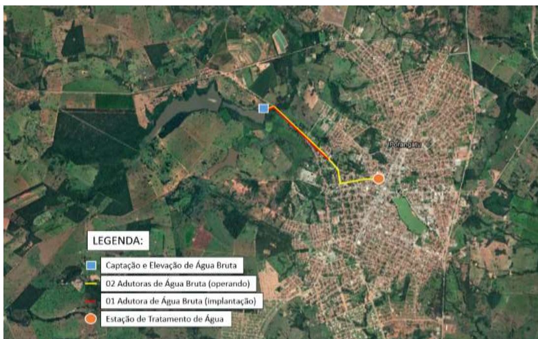
Figura 29: Esquema do atual Sistema Funil de captação e adução de água bruta
